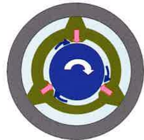
砥石軸受 マッケンゼンタイプ非接触油動圧軸受
